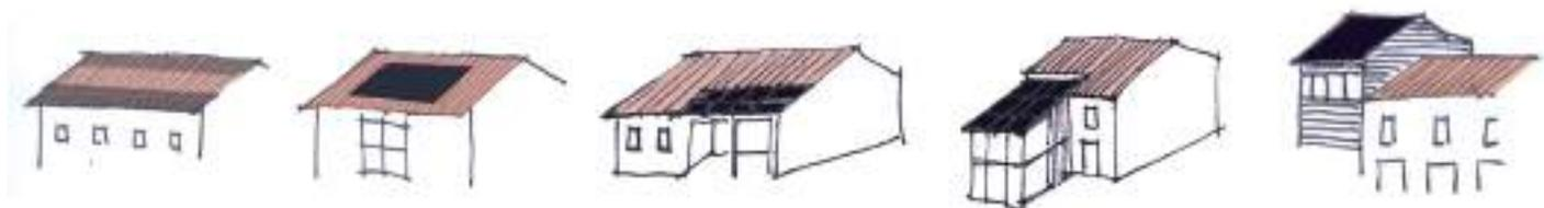
Exemples d'intégration des panneaux sur un bâtiment d'habitation existant : en bande sur toute la longueur de toiture, centrée sur l'axe d'une ouverture, sur une serre, un auvent, une véranda, sur toute une partie de l'habitation ...
